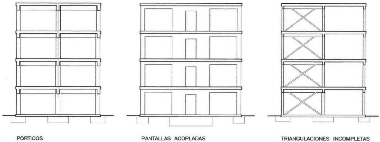
Figura 3.4.- Ejemplos de organizaciones estructurales que permiten un valor del coeficiente de comportamiento por ductilidad \mu = 4 .
