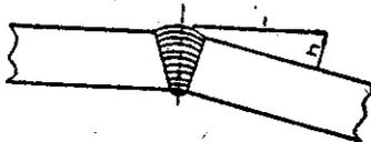
3.º Falta de espesor de soldadura: 0 milímetros.
